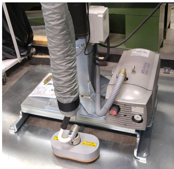
Lyften drivs effektivt av en vakuumpump
