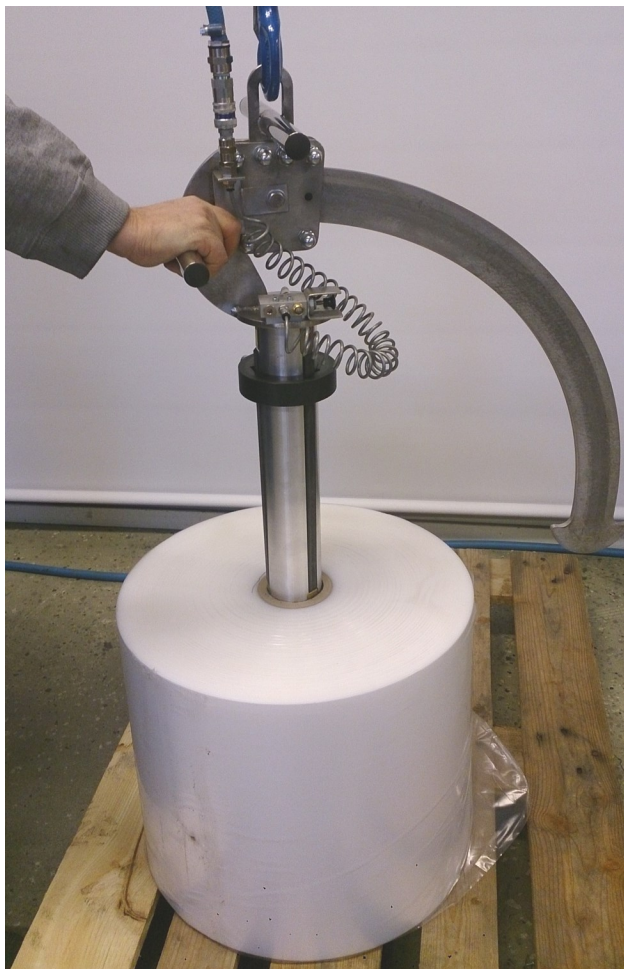
Styr in expanderdonet i hylsan. Vid behov ställ in djupstoppet för att aktuell rulle ska vara utbalanserad i vridcentrumet.
