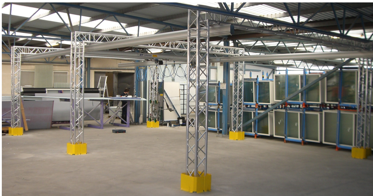
Skensystem med enkeltravers placerat i 3st. Trossbågar.
