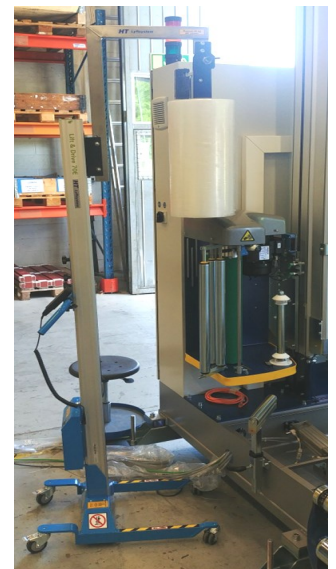
Mekanisk rullexpander på anpassad lyftbom
