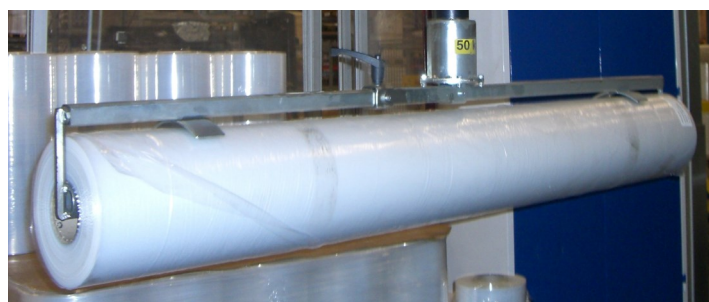
Mekaniskt verktyg för hantering av långa rullar
