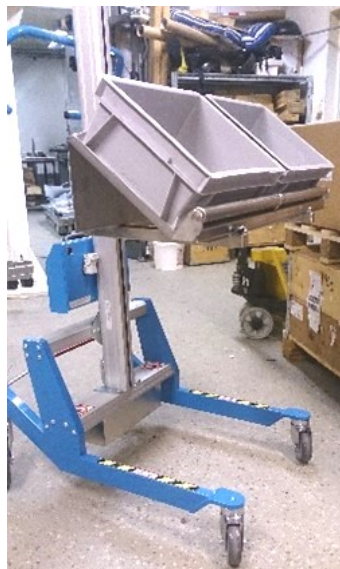
Anpassat lastflak med frontrulle
