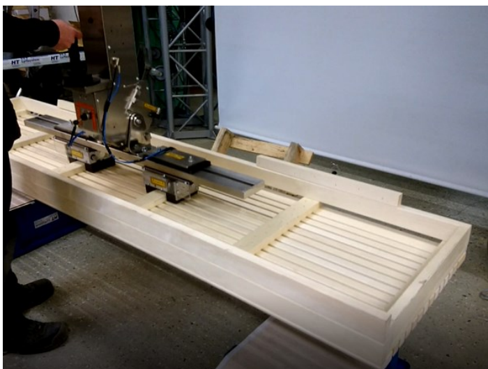
Specialanpassat klämverktyg för hantering av bastulavar.
