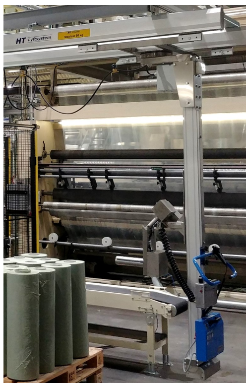
Taklyftpelare med pneumatisk expander för lyft och rotering.
