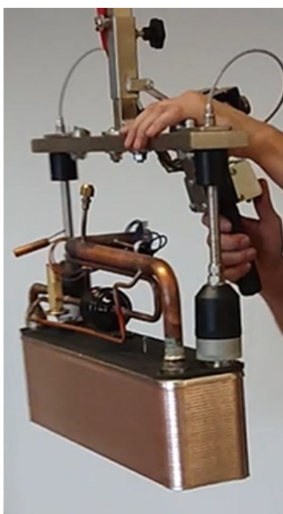
Klämverktyg till värmeväxlare.
