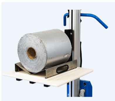
Flak med V-block, kombinerat med snurrskivan roterar V-blocket så att rullen kan positioneras rätt.
