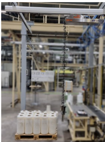
AirHandle AHR - med ett pneumatiskt verktyg för att lyfta rullarna i centrum.
