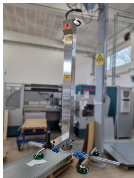
AirHandle AHS - med vakuumbgripdon med tiltfunktion för att hantera plåtar.
