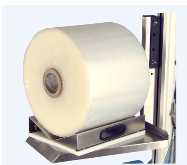
Flak med V-block, kombinerat med snurrskivan roterar V-blocket så att rullen kan positioneras rätt.
