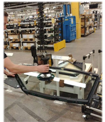
Utbalanserat läge, det går bra att hantera godset genom att hålla direkt i det.
