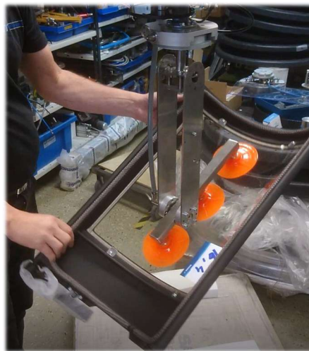
Utbalanserat läge, det går bra att hantera godset genom att hålla direkt i det.
