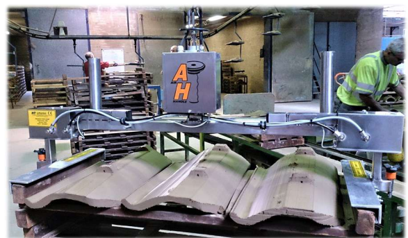
Utbalanserat läge, det går bra att hantera godset genom att hålla direkt i det.
