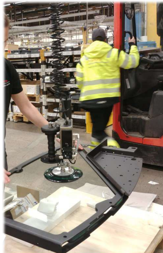
Utbalanserat läge, det går bra att hantera godset genom att hålla direkt i det.
