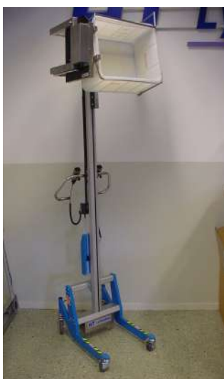
Hantera backarna med lyftvagn med tippfunktion för tömning framåt eller i sidled.
