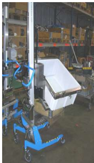
Hantera backarna med lyftvagn med tippfunktion för tömning framåt eller i sidled.
