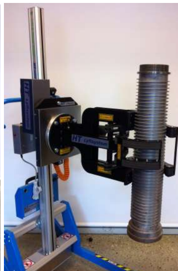
Elektriskt kläm-gripdon för cirkulärt gods. Kombineras gärna ihop med en elektrisk vridmodul.
