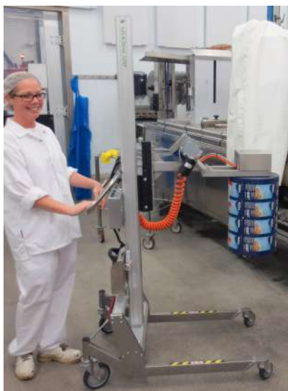
Pneumatisk expander som greppar i rullens kärna.
