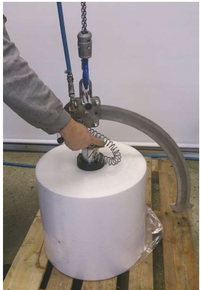
Aktivera pneumatiken genom att trycka in knappen - rullen låses. Hållkraft. 6 kg / 10 mm expanderdon med gummilist.
