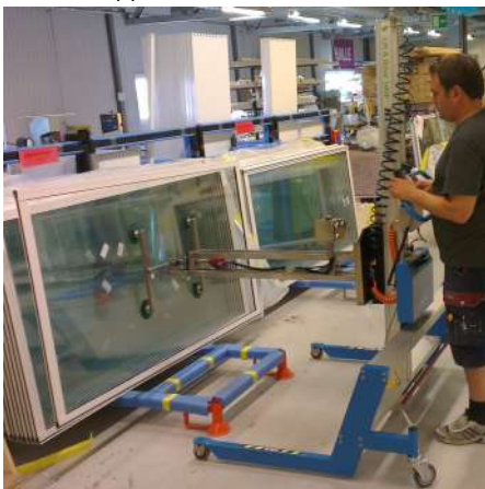
Kundanpassat vakuumverktyg för hantering av fönsterrutor.
