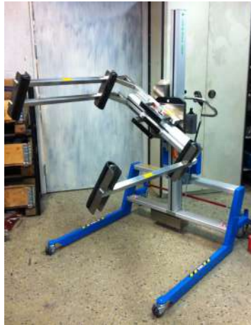
Lyftvagn med kundanpassat kläm- och vridverktyg.
