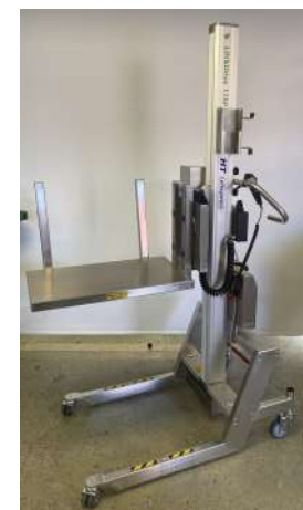
Läkemedelsindustrin, här med ett kundanpassat flak som kan tippas för hantering av säckar.
