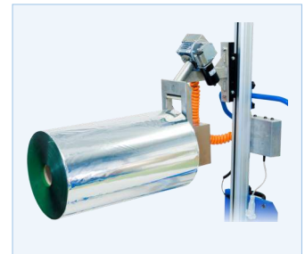
Pneumatisk expander, lyfter i rullens kärna och vrider 360°.
