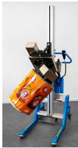
Pneumatisk expanderverktyget. Greppar i kärnan, lyfter och vrider.
