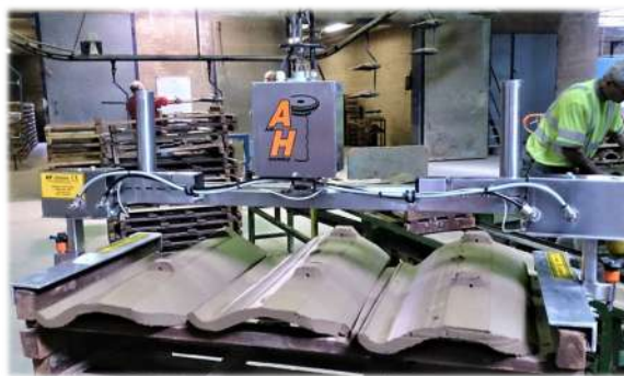
Utbalanserat läge, det går bra att hantera godset genom att hålla direkt i det.
