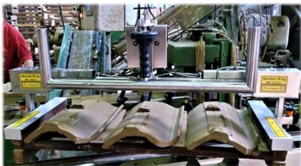
Utbalanserat läge, det går bra att hantera godset genom att hålla direkt i det.
