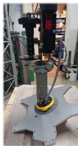
Utbalanserat läge, det går bra att hantera godset genom att hålla direkt i det.
