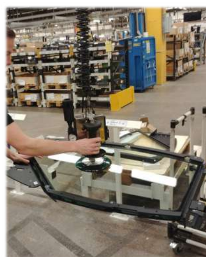
Utbalanserat läge, det går bra att hantera godset genom att hålla direkt i det.
