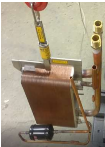
Ett litet mekaniskt klämverktyg för hantering av värmeväxlare
