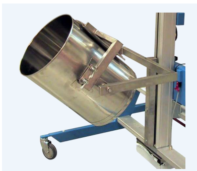
Kundanpassat klämverktyg med tippfunktion.
