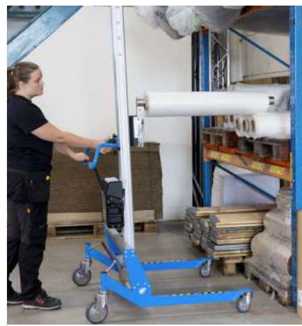
Lyftvagn med ett mekaniskt rullspjut för hantering av liggande rullar.
