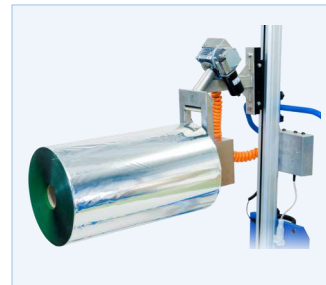
Pneumatisk expander, lyfter i rullens kärna och vrider 360°.
