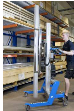
Teleskopmast för extra lyfthöjd. Den främre masten kan sänkas vid behov – perfekt för att enkelt passera genom dörröppningar.
